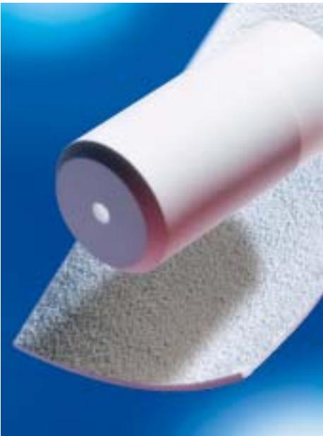
*Poröses PTFE kann die Funktion der Atmung übernehmen, d. h. einen Gasaustausch gewährleisten, gleichzeitig aber vor dem Eindringen von Flüssigkeiten schützen*
