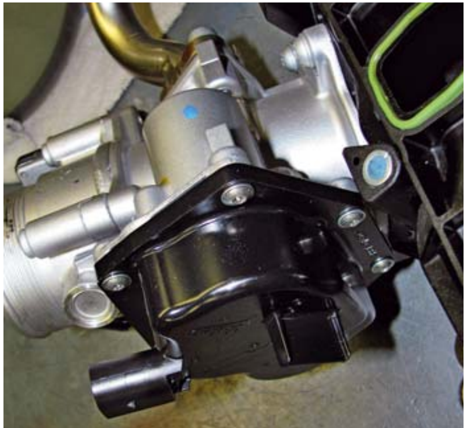
Mithilfe einer Abgasrückführung lassen sich Schadstoffemissionen reduzieren
