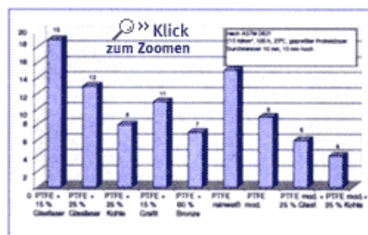
Bild 4: Der Kaltfluß von PTFE/TFM-Compounds lässt sich durch FÜLLstoffvariation variieren
