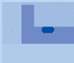
Einspannflansch mit zusätzlicher O-Ring-Abdichtung.
